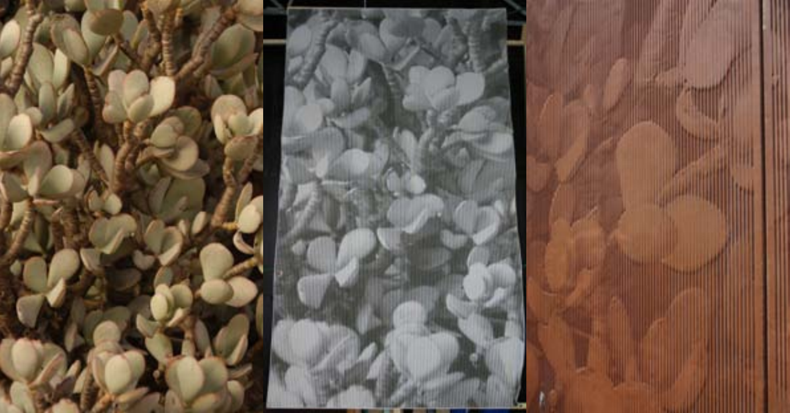
Vom Foto zum Betonelement: Original-Foto, Matrize und Betonteil
